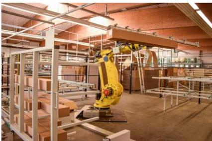
Roboter SIGI bei der Arbeit. Er entlastet die Mitarbeiter im Versand indem er Hebe- und Sortiertätigkeiten von Paketen mit einem Gewicht bis zu 100 kg übernimmt.
